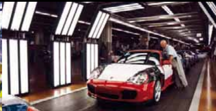
Im Lichttunnel wird die Lackierung geprüft.
