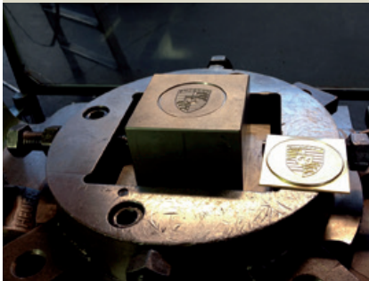
Prägewerkzeug zur Prägung in die Platine.
