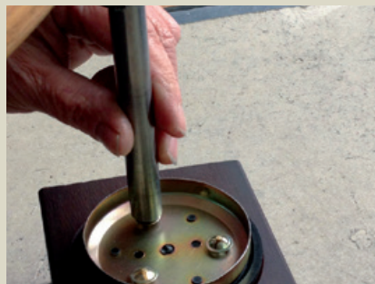
Zusammenbau der Einzelteile durch Anbringen der Federmuttern.
