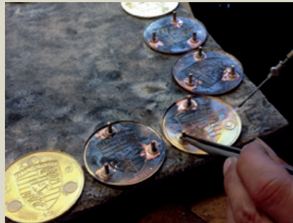
Hartlöten der Stifte nach Ausstanzen der Platine.
